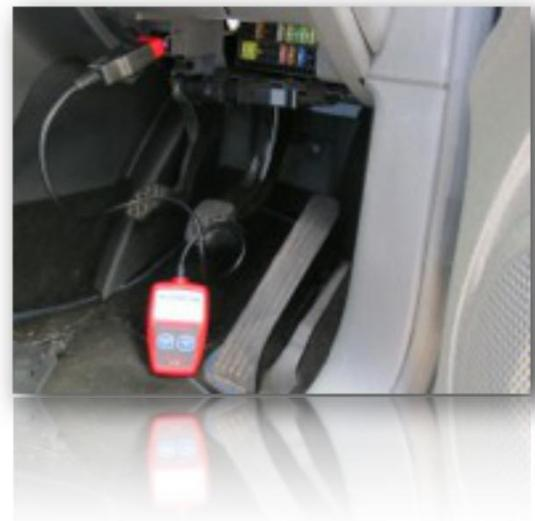
9. Verifica que tiene corriente el nuevo puerto instalado de OBD conectando una máquina de diagnóstico y entrando en funcionamiento.
