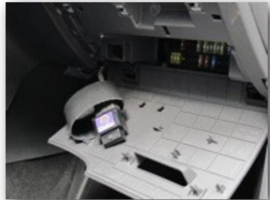
5. Aplique calor con la pistola. Comprobará que poco a poco la goma quedará totalmente compactada y adherida al OBD BLOCER y conector del cable.
