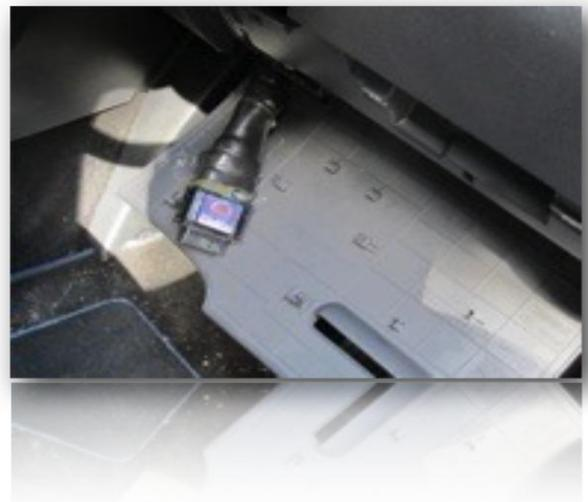
6. Coloca el cable nuevo en la posición donde se encontraba el OBD del vehículo y déjalo ajustado.
