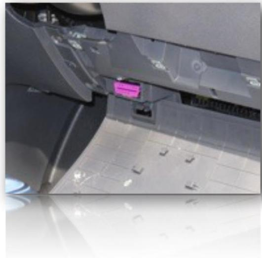
2. Retire el puerto OBD existente de su lugar de montaje utilizando un kit de desmontaje y herramientas.
