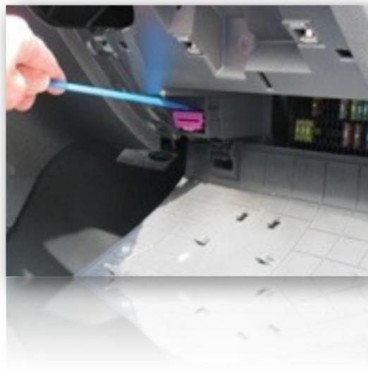
3. Conectar el OBD Blocker al conector OBD del vehículo, asegurándose que el cable que conecta es el correspondiente al vehículo.
