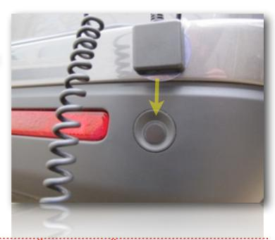
ПОМНИТЕ, ЧТО ВНУТРЕННИЙ И ВНЕШНИЙ ДАТЧИКИ ТЕСТЕРА ПОКАЗЫВАЮТ НЕМНОГО ОТЛИЧАЮЩИЕСЯ РЕЗУЛЬТАТЫ. ВСЕГДА ПРОВОДИТЕ ТЕСТЫ ВСЕХ ДАТЧИКОВ ПАРКОВКИ ОДНИМ И ТЕМ ЖЕ ДАТЧИКОМ. В ПРОТИВНОМ СЛУЧАЕ ВЫ ПОЛУЧИТЕ НЕКОРРЕКТНЫЕ РЕЗУЛЬТАТЫ.
